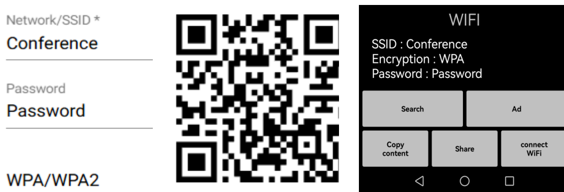
Рисунок 3 – Кодирование и декодирование QR-данных для сети WiFi
