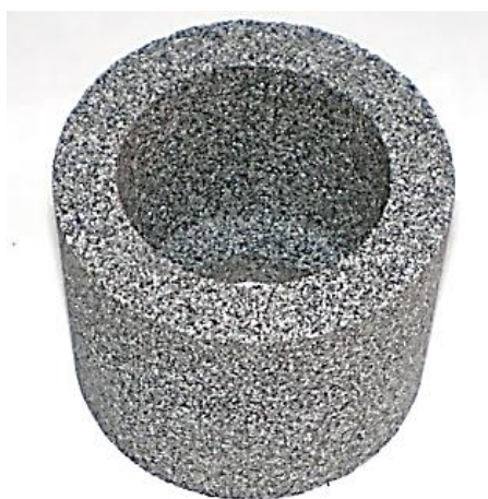
Рисунок 2 – Высокопористый экспериментальный шлифовальный круг ЧЦ 60 х 50 х 25 25А F60 С64 F46 15V
