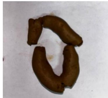
**Рисунок 6 – Шнур сплошной и кольцо в трещинах (образец № 3 из слоя 4) (фото автора)**
