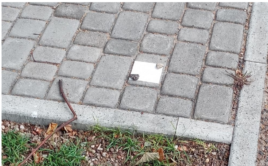
Рисунок 3 – Отбор проб при помощи фильтровальной бумаги
