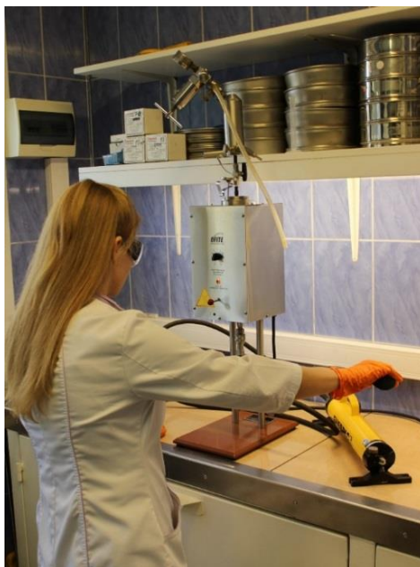
Рисунок 2 – Тестер определения проницаемости тампонирующих материалов производства OFITE ( PPT – Permeability Plugging Tester ) (фото автора)
