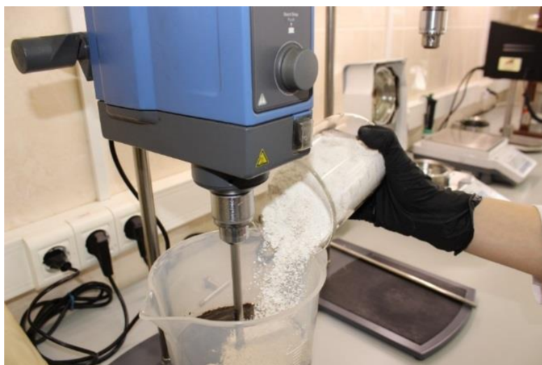
Рисунок 1 – Ввод карбонатного наполнителя при приготовлении бурового раствора
