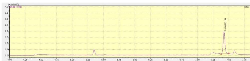
Рисунок 5 – ГХ-МС-хроматограмма пробы красящего вещества синего цвета капиллярной ручки марки deVENTE до УФ-воздействия
