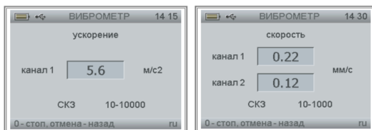
Рисунок 2 – Измерение параметров вибрации
