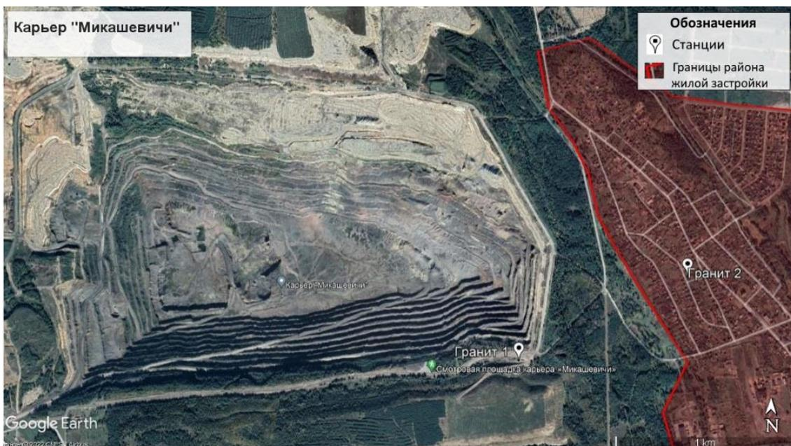
**Рисунок 1 – Схема карьера «Микашевичи» и места установки сейсмических станций (Гранит 1 и Гранит 2)**
