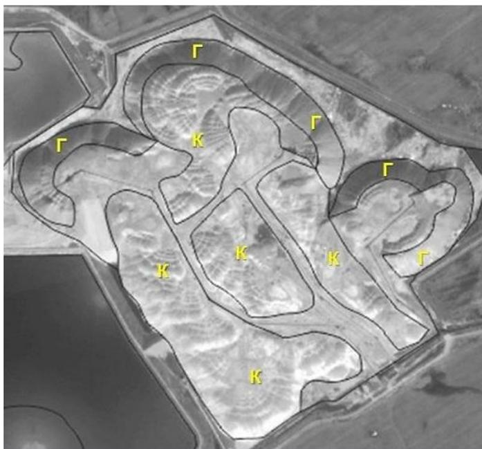
**Рисунок 3 – Отображение на космическом снимке проявлений гравитационных (Г) и карстовых (К) процессов в пределах солеотвального комплекса ЗРУ Старобинского месторождения калийных солей**
