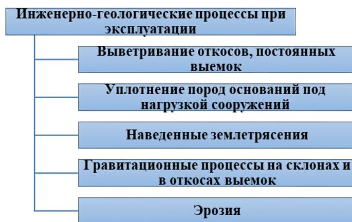
**Рисунок 2 – Классификация инженерно-геологических процессов при эксплуатации горных выработок (составлено автором по данным [1])**
