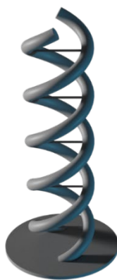
Рисунок 1 – модель элемента метаматериала в виде двойной спирали, пригодная для 3D-печати
