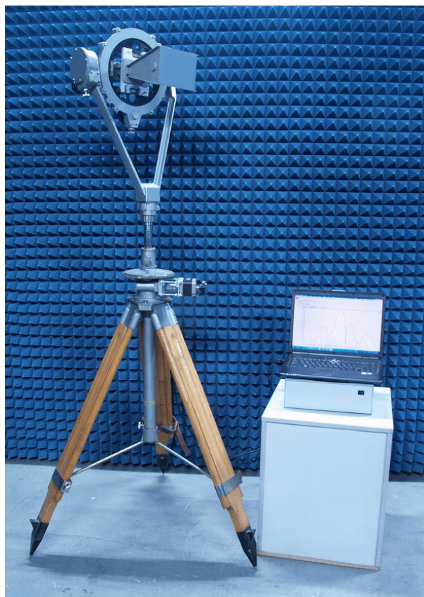
Рисунок 4 – Беззочная камера с блоком управления аппаратно-программного комплекса ЮСТ FarField с портативным компьютером, а также опорно-поворотное устройство с антенной П6-126
