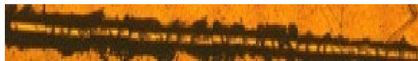
Рисунок 4 – Фрагменты морфологии поверхности после проведения скрэтч-анализа: покрытие криогенно обработанное в течение 72 часов
