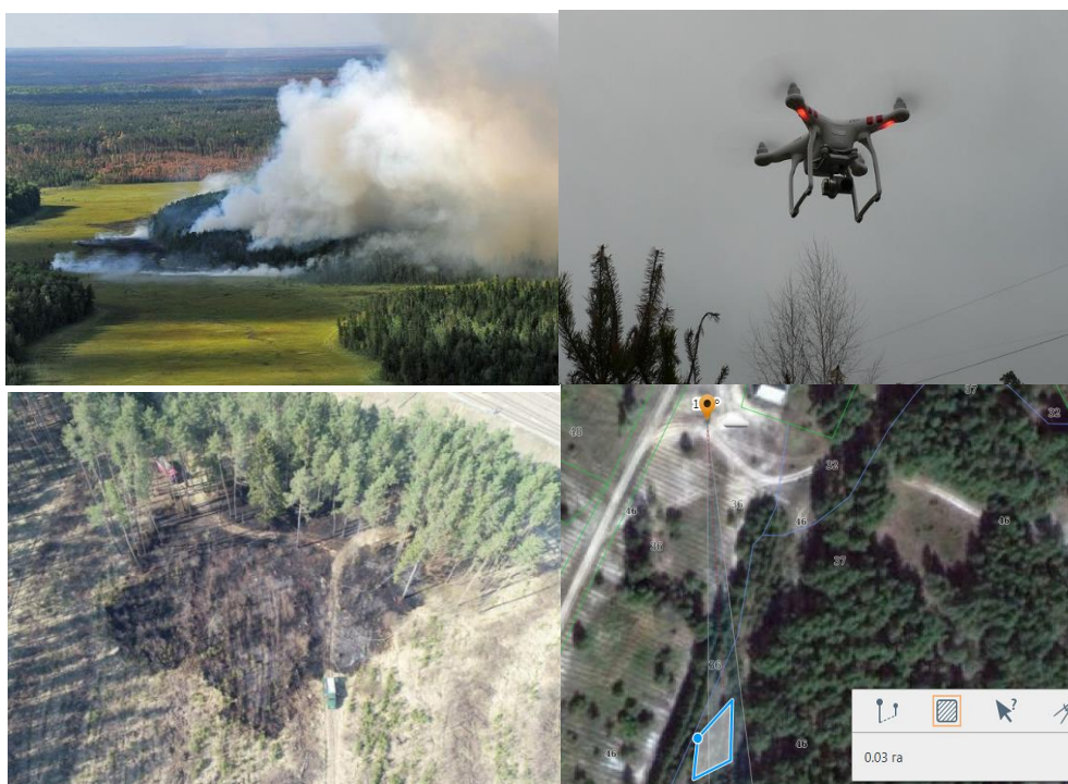
Рисунок 2 – Пример облета БПЛА контролируемой территории с уточнением GPS координат и возможностью подсчета площади очага поражения
