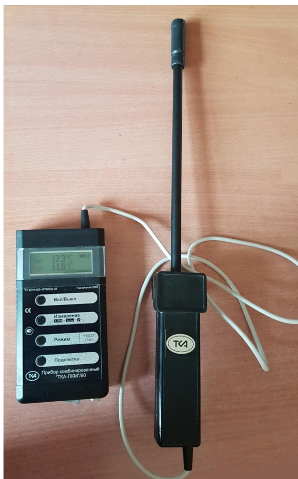
Рисунок 2 – Прибор ТКА – ПКМ для измерения параметров микроклимата
