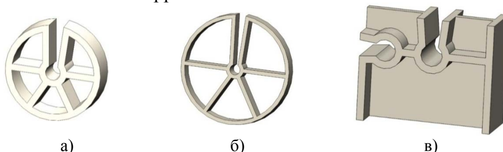
Рисунок 1 – 3D-модель фиксатора арматуры различной конструкции а) – колесико 30×4; б) – колесико 60×5; в) – универсальный
