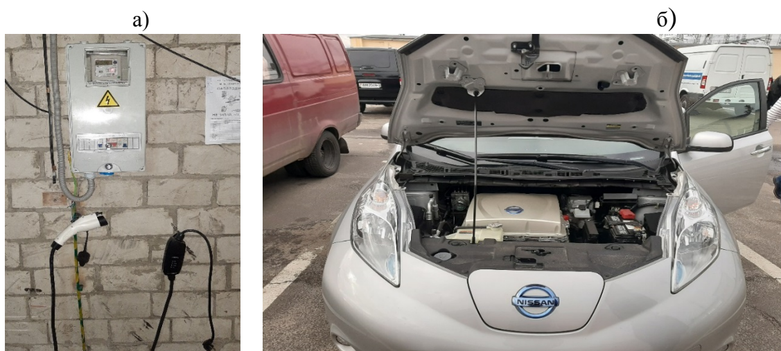
Рисунок 1 – Зарядное устройство с питанием от электросети 220В (а) и электро-мобиль для исследований: 1 – зарядный порт; 2 – АКБ
