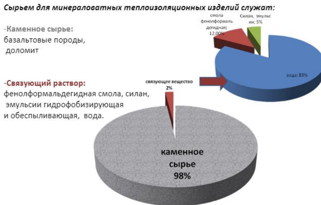
Рисунок 1 – Состав минераловатной плиты
