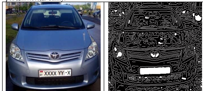
Рисунок 1 – Сегментация номерного знака с помощью метода Canny
