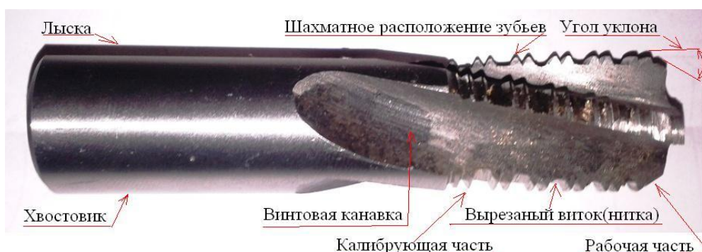
Рисунок 2 – Альтернативное исполнение метчика \frac{1}{2} "
