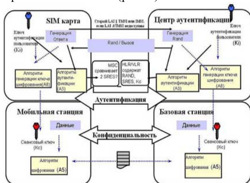
Рисунок 1 – Схема аутентификации для сетей GSM
