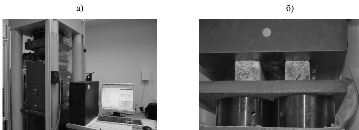
а – пресс ToniNorm2041 ; б – сжатие образцов прямоугольной формы одинаковой ширины
