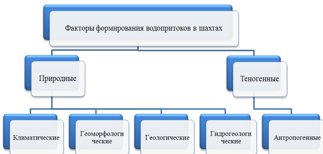
Рисунок 3 – Блок диаграмма факторов формирования водопритоков в подземные горные выработки
