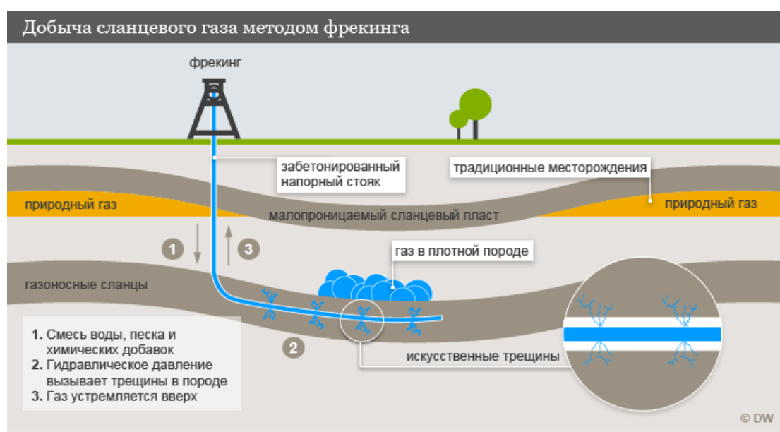
Рисунок 1 – Схема добычи сланцевого газа методом фрекинга (ГРП)
