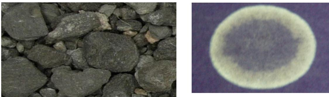
**Рисунок 2 – Фотография бурового шлама георгиевской свиты в бинокулярном микроскопе и капиллярная вытяжка**
