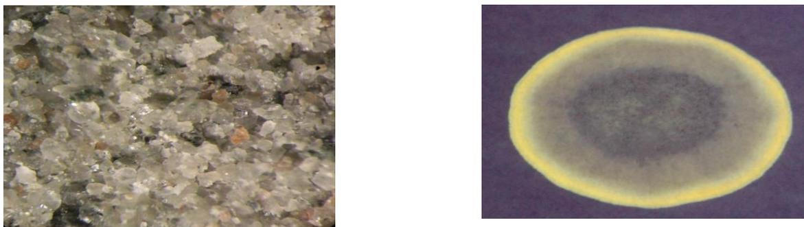
**Рисунок 3 – Фотография бурового шлама пласта-коллектора ЮВ1/1 васюганской свиты в бинокулярном микроскопе и капиллярная вытяжка**
