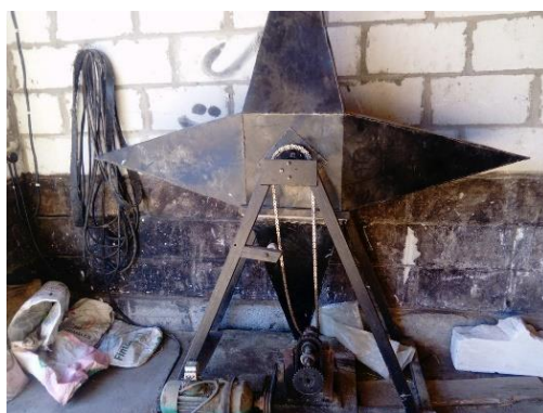
Рисунок 1 – Конструкция смесителя биологических добавок и аминокислот
