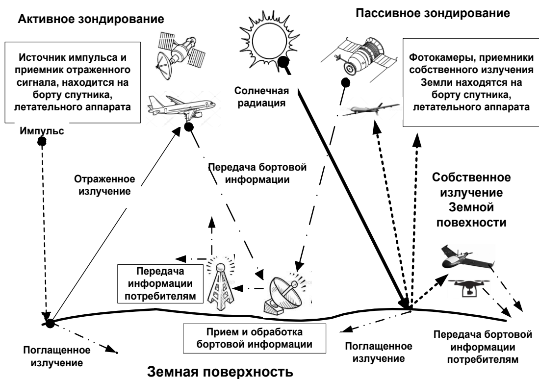
Рисунок 1 – Схема дистанционного зондирования земной поверхности
