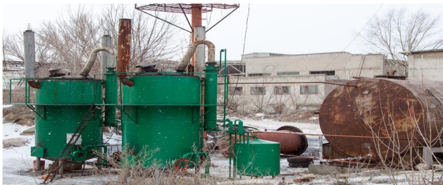
Рисунок 1 – Установка «Fortan4» по переработке промышленных отходов
