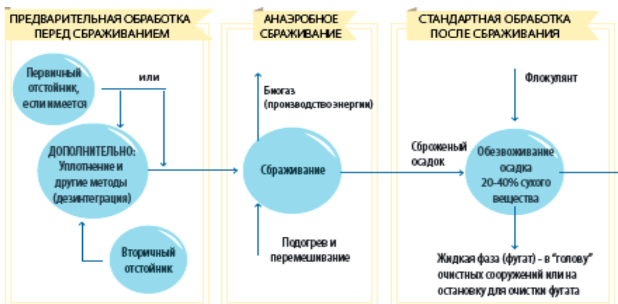
Рисунок 1 – Схема анаэробного сбраживания
